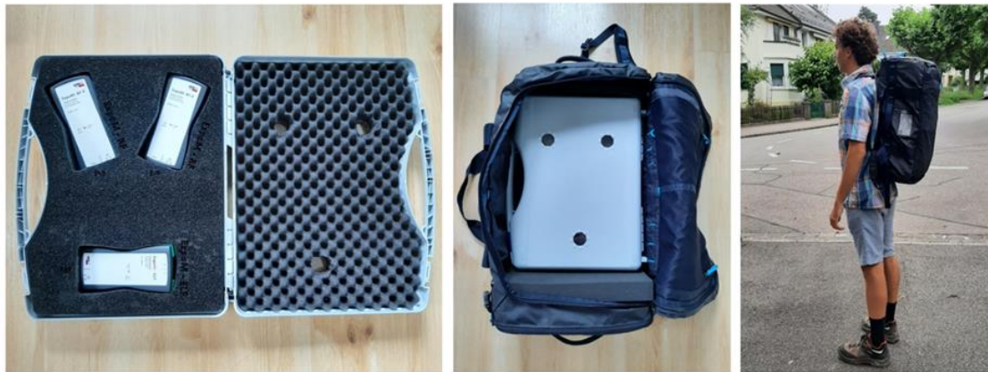
Figure 2: Illustration du setup pour les mesures d'itinéraires. À gauche : Trois appareils de mesure (deux ExpoM-RF4 et un ExpoM-ELF) sont fixés dans une valise remplie de mousse. Centre : La valise est placée dans le sac à dos et fixée avec de la mousse. À droite : la personne chargée des mesures porte le sac à dos contenant les appareils de mesure à une distance de 20 cm de son corps et à une hauteur de 160 cm.
